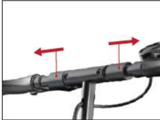
Étape 2: Dévissez et tirez les manchons de verrouillage vers l'extérieur pour relâcher les poignées
